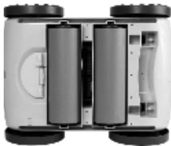
8.1: Manuell die Green-Laufrollen drehen. Sie sollen sich leicht drehen. Wenn Fremdkörper die Rotation blockieren, entfernen Sie sie.
