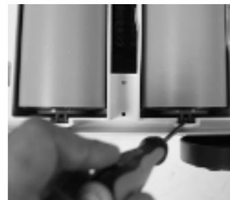
8.2: Wenn Fremdkörper nicht leicht zugänglich sind, verwenden Sie einen flachen Schraubenzieher, um die Rollen vorübergehend zu entfernen. Drücken Sie die Lasche wie im Bild gezeigt, um die Laufrollen zu entfernen.
