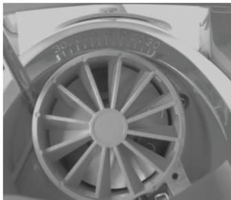
7.1: Entfernen Sie die Klappeneinheit, um den Schmutz oder die Haare am Impeller zu reinigen
