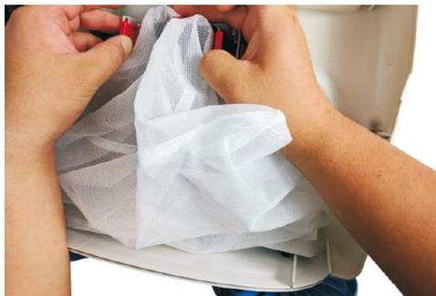
6.2 Ziehen Sie die roten Laschen auf einer Seite zurück und heben Sie den Beutelrahmen an dieser Seite vollständig an.
