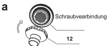
Schrauben Sie den Z Schlauchanschluss B (12) von der Innenseite des Pools an die Schraubverbindung.
