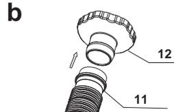
Schließen Sie das andere Ende des Skimmerschlauches (11) an den Schlauchadapter B (12) an.
