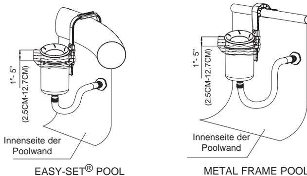
**WICHTIG:** Der Skimmer muss immer senkrecht zur Wasseroberfläche sein, sodass die schwimmende Abdeckung parallel zur Wasseroberfläche liegt.
