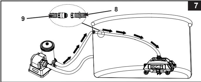
9. Schalten Sie die Filterpumpe ein und stellen Sie sicher, dass Wasser durch den Schwimmbadreiniger fließt. Der Schwimmbadreiniger bewegt sich nun und saugt den Beckenboden. Siehe Abb. 8.
