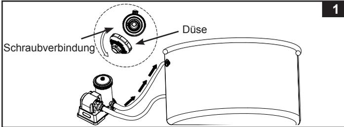
2. Schrauben Sie das Ende des Schlauches A (8) mit dem Adapter auf das Gewinde der Schraubverbindung an der Innenseite des Pools. Siehe Abb. 2.
