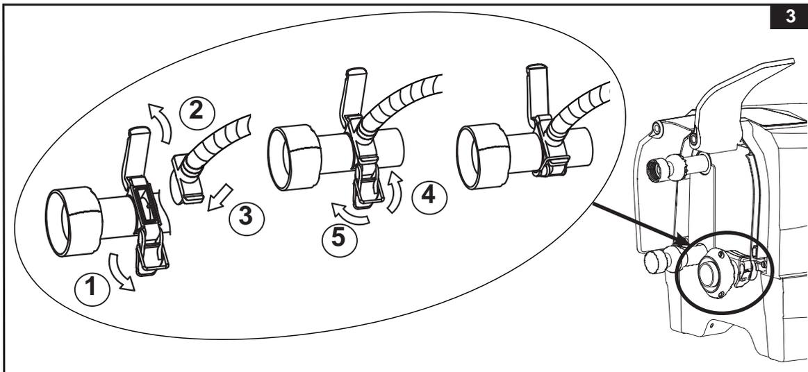
3. Schrauben Sie die Luftventilkappe am Whirlpool ab, um auf den aufrecht stehenden Ventilschaft zum Aufpumpen zuzugreifen. Schieben Sie das andere Ende des Füllschlauchs (7) in das Ventil und drehen Sie es nach rechts, um es in dieser Position zu verriegeln. **Siehe Abb. 4.**
