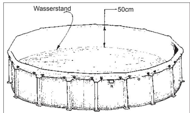
Füllen Sie das Schwimmbecken bis ungefähr 50 cm unter die Randschienen. Achten Sie darauf, dass die Folie während des Befüllens nicht zurück in das Becken fällt. Wasser zwischen der Folie und der Stahlwand kann den Wall beschädigen (siehe Schritt 9). Vollenden Sie erst die Schritte 15, 16 und 17, bevor Sie mit dem Befüllen des Pools fortfahren.
