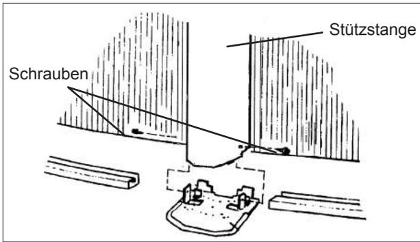
Montieren Sie jetzt die Vertikalstützen so, dass sich das Schraubloch an der Vorderseite der Stützstange oben befindet. Die Teile werden mit Blechschrauben miteinander verbunden. Ein Tropfen Öl auf die Blechschrauben erleichtert die Arbeit.
