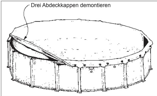
Mit der Hilfe von zwei oder drei Personen entfernen Sie die Klammern von drei Abschnitten und lösen die Folie. Achten Sie darauf, dass Sie die Folie nicht ins Wasser fallen lassen. Während eine Person die Folie festhält, demontiert ein anderer die Abdeckkappen, Randschienen und die Endplatten (siehe Abb.)
