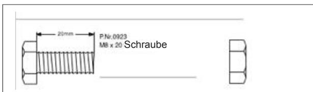
Das/die Band/Bänder vom Typ (B) mit den bereits montierten Bändern vom Typ (A) verbinden mittels fünf Schraubensätzen M8x20 mm und einer Mutter M8.
