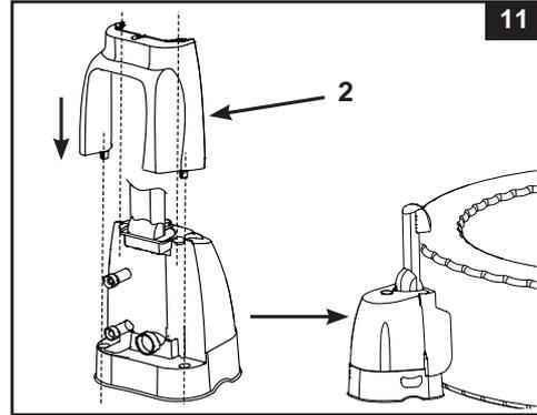
3. Bringen Sie das montierte Gehäuse für die Filterpatronen am Auslassgitter auf der Innenseite der Whirlpool-Wanne an (in der niedrigeren, mit "C" markierten Position) **Siehe Abb. 12**. Pumpen Sie den Whirlpool auf bevor Sie die Filterpumpe installieren.
